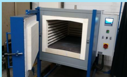
1 four de traitement thermique capacité 400 x 600 x 1000
